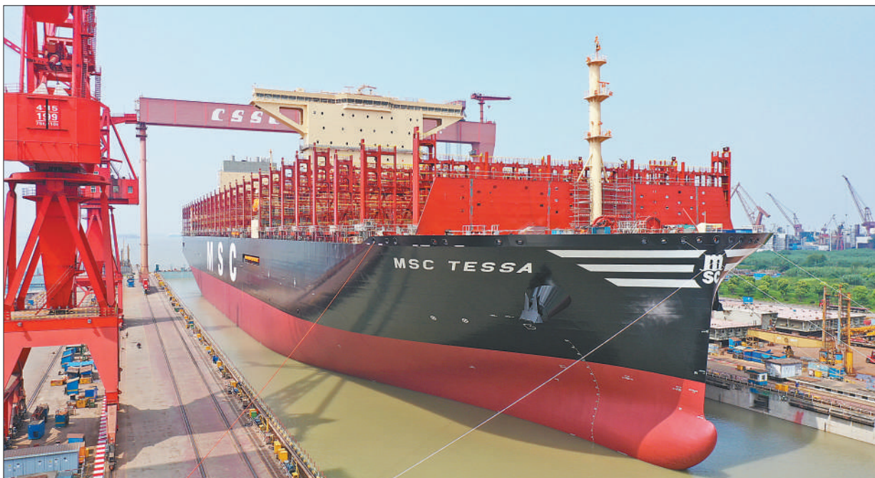
8月1日,由沪东中华造船(集团)有限公司为地中海航运公司(MSC)建造的24116TEU超大型集装箱船在上海长兴造船基地出坞。这是迄今为止全球载箱量最大的集装箱船。该船由沪东中华自主设计,总长399.99米,型宽61.5米,甲板面积相当于近4个标准足球场,可承载24万多吨货物。该船还首次采用气泡减阻系统,能有效降低船舶总能耗,减少温室气体排放。
