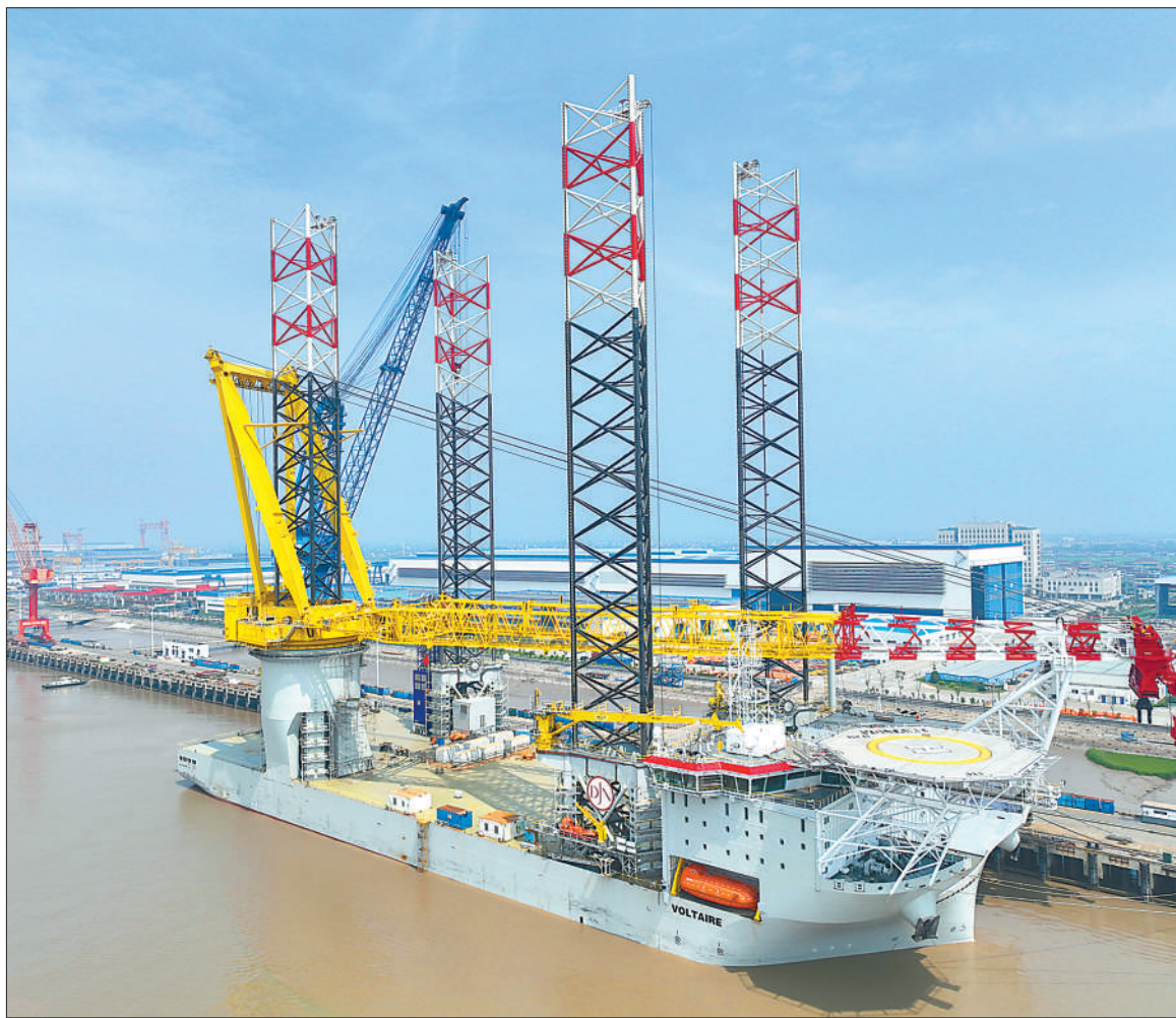
7月17日,在江苏启东中远海运海工码头,由中企为比利时定制的N966自升式风电安装船内部调试有序推进。这是世界首艘3000吨级自升式风电安装船。许丛军摄(影像中国)
