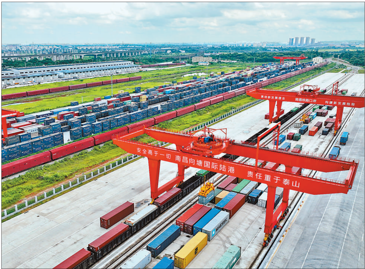
近日，随着江西南昌国际陆港二期海关监管场所开通，南昌国际陆港全面建成运行。图为7月7日，在南昌国际陆港，龙门吊正在进行集装箱装卸作业。胡国林摄(影像中国)
