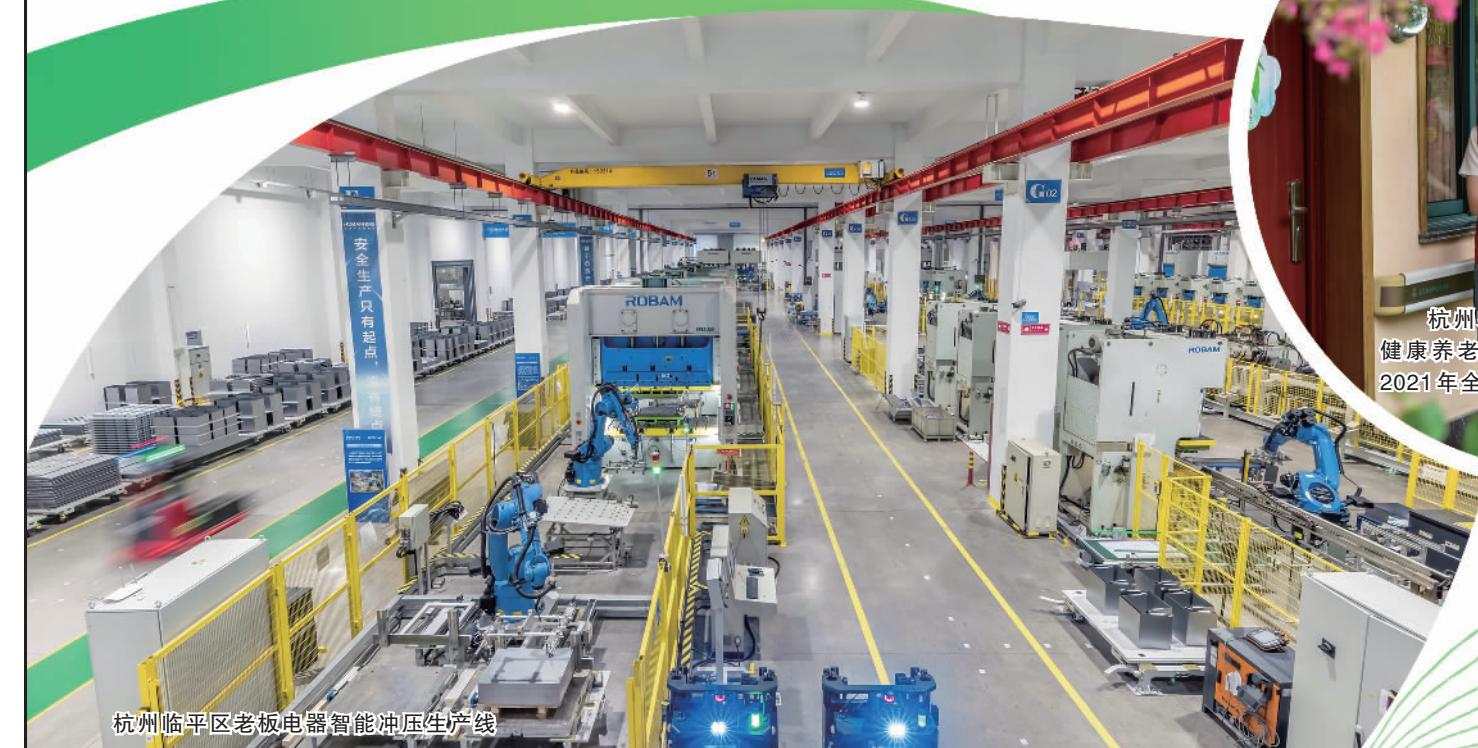
杭州临平区老板电器智能冲压生产线
