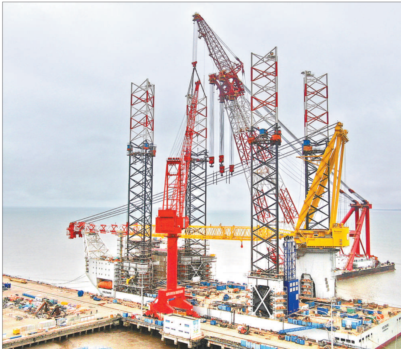
4月24日,在江苏启东中远海运海工码头,比利时订制的N966自升式风电安装船的吊装作业完成,进入完工调试阶段。这是世界上首艘第四代风电安装船,具有起重能力强、操控性好、空间容量大、能耗及排放低等优点,交付后,不仅能够安装下一代风电机组和底座,也可用于石油和天然气行业。
