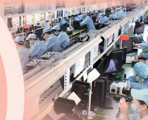
武汉高德红外股份有限公司智感科技制造部，装配工人正有条不紊地进行多款民用红外热成像设备的焊接、组装等工作
