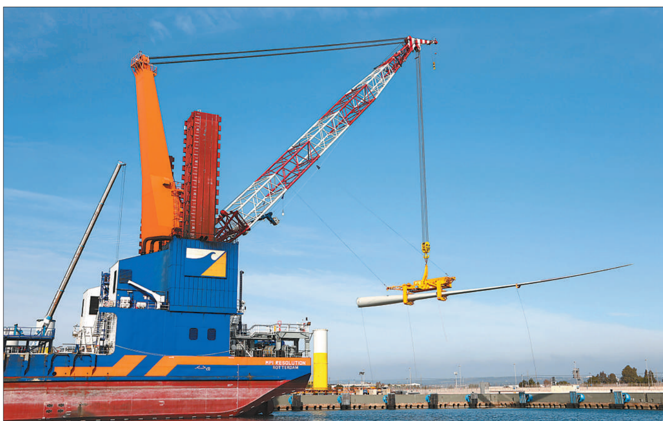
意大利南部的塔兰托港正在建设风电项目，中国明阳智慧能源集团股份公司为该项目提供了10台风电整机，总功率为30兆瓦，可以满足近两万个家庭的用电需求。图为作业船近日在塔兰托港吊运中企提供的风电叶片。
