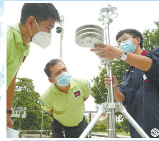
图②：2021年9月，在柬埔寨理工大学，中方人员向柬方技术人员讲解颗粒物分析仪采样部分的基本结构和原理，并对其进行使用操作及日常维护的培训。
