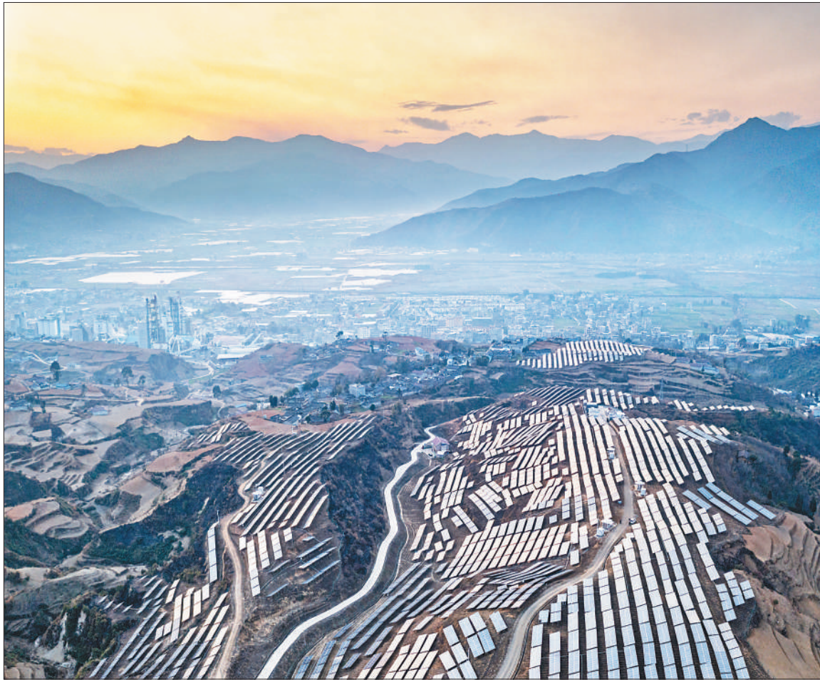
近日，远眺四川省凉山彝族自治州冕宁县泸沽镇大田村光伏电站，风光秀美，景观壮丽。大田村光伏电站采用农光互补模式，使用太阳能发电的同时，还可利用板间和板下的土地种植植物。 刘国兴摄（影像中国）
