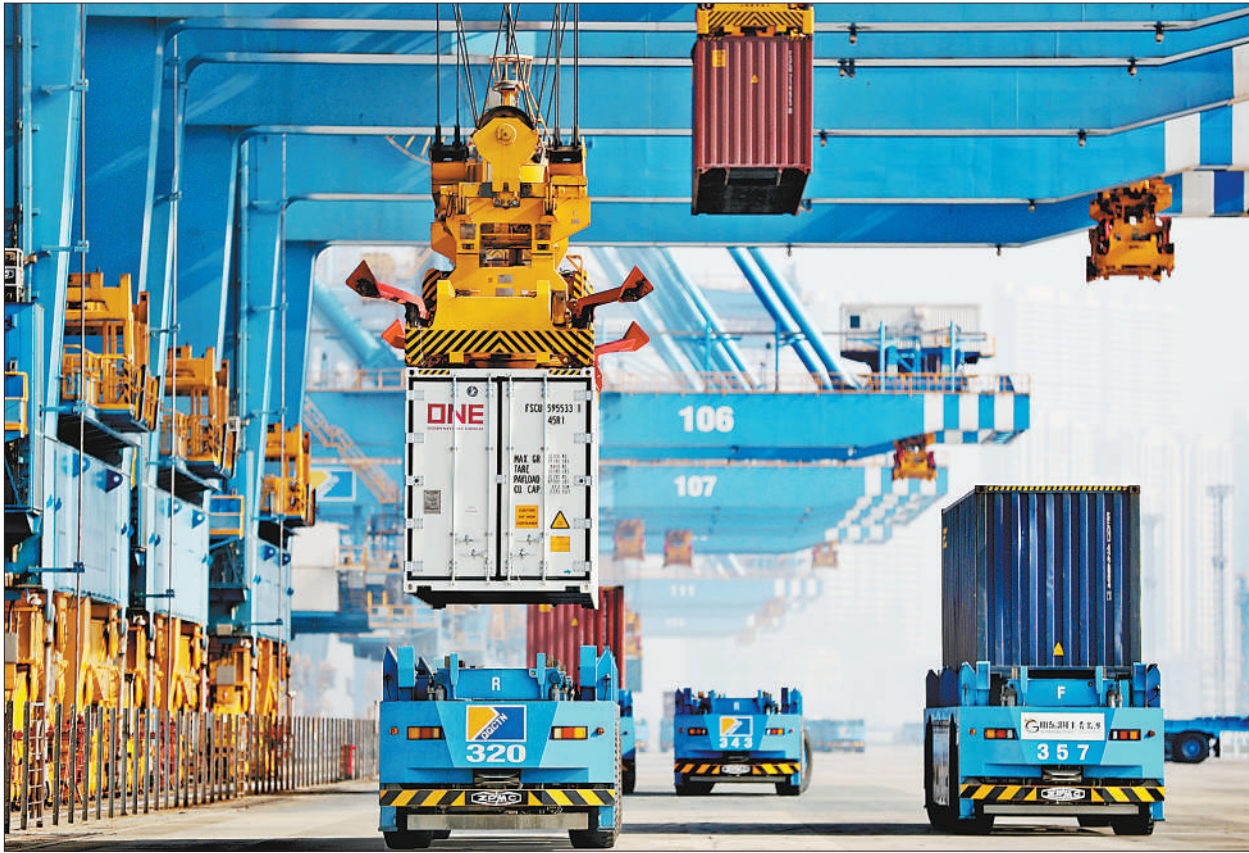
今年1月至11月，山东港口新增集装箱航线33条，其中共建“一带一路”国家和地区航线总数达14条。图为在山东港口青岛港全自动化码头，自动导引车来回穿梭装运货物。
