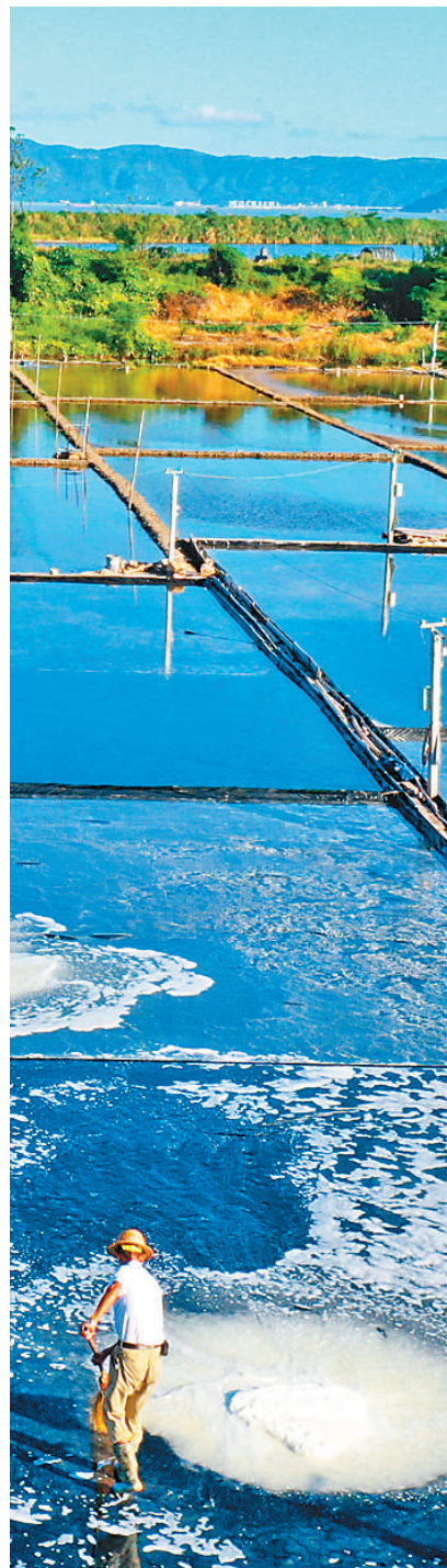
8月29日,浙江温州乐清湾畔的南塘晒盐场,盐民在劳作晒盐。该盐场采用蒸发、调卤、结晶等方法制盐,保留了古法晒盐技艺。
