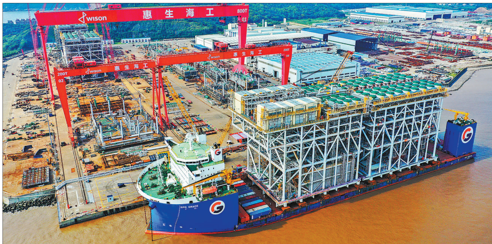
8月26日,一艘装有全球最大集成管廊模块的驳轮启程,驶往俄罗斯。届时,该集成管廊将作为管线、管路的通道,应用在北极二液化天然气项目中。图为出发前夕,驳轮停靠在浙江舟山市秀山基地生产码头。
