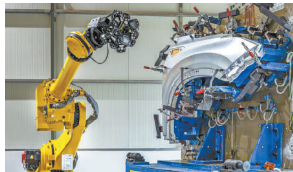
长安汽车智慧工厂里,机器人正在进行车身精度检测。资料图片
