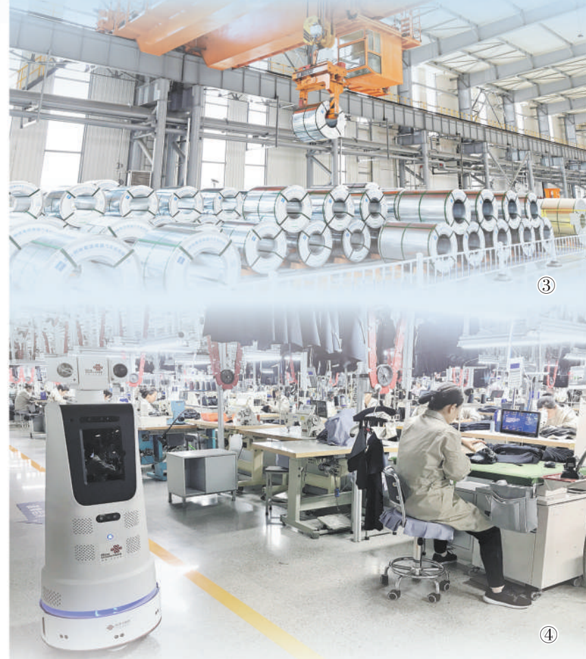
图①:海南海口市美德村村民正在村卫生室用5G医疗一体机做身体检查。戴瑞摄 图②:上汽自动驾驶重卡在洋山港码头进行吊装作业。文籍摄 图③:河钢集团唐钢公司高强汽车板产线成品库,在5G技术支持下,无人天车正进行发货作业。赵辉摄 图④:雅戈尔西服智能工厂,5G智能巡检机器人正在检查生产线。尚海宇摄
