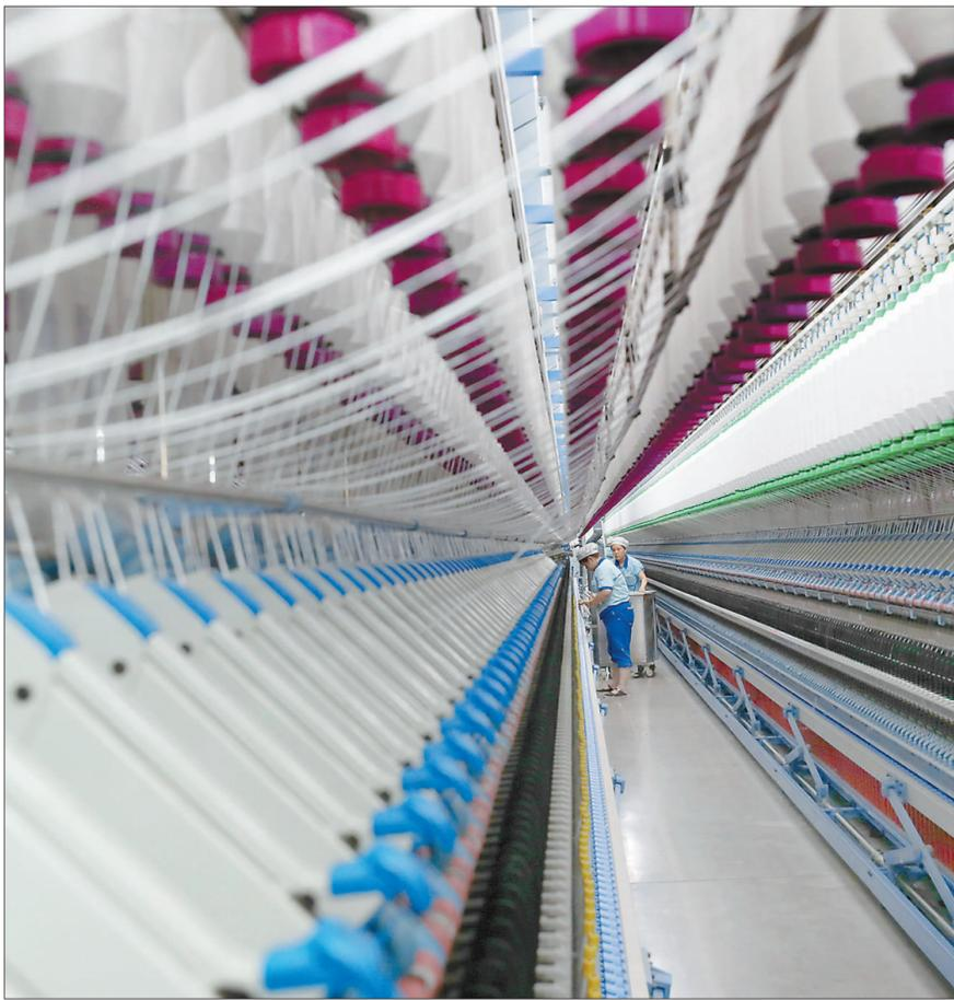
6月15日,江苏省南通市崇川区的一间数字化纺纱车间内,生产线正在繁忙运转。数字化纺纱车间采用全流程国产设备生产线,生产效率提高10%以上,吨纱综合成本下降1000多元,实现了纺纱自动化、智能化。
