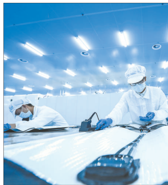
贵阳移动能源产业园薄膜太阳能汉瓦生产线。 资料图片
