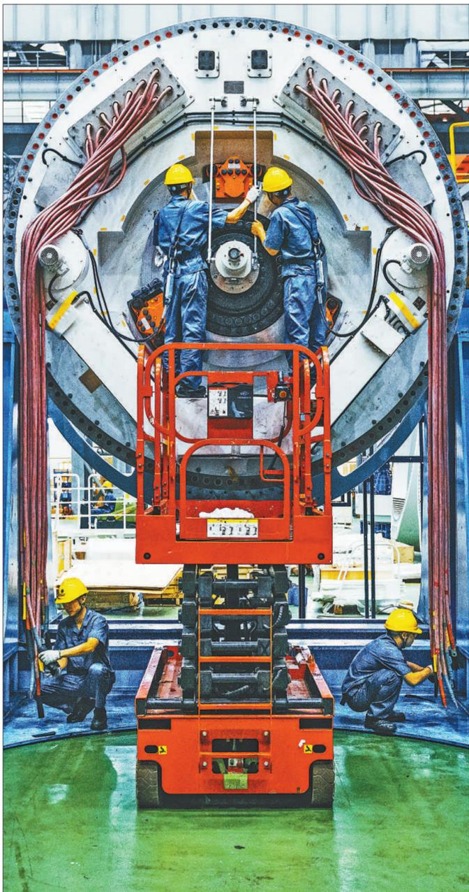
广东省阳江市阳江智能制造中心研发、生产国际领先的大型海上风电整机及其关键部件，其产品畅销海内外市场。图为日前中心整机装配车间里，工人忙着对轮毂进行配件安装。
