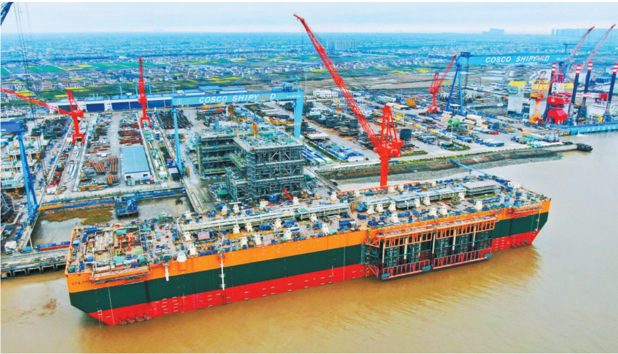
3月19日,由江苏启东中远海运海洋工程有限公司承建的FPSO(浮式生产储卸油船)顺利出坞,将进行生活区等设施的建造与安装。这是中国船企首次为非洲项目建造的浮式生产储卸油船,交付后将赴毛里塔尼亚、塞内加尔等国家运输天然气。 许丛军摄 (影像中国)
